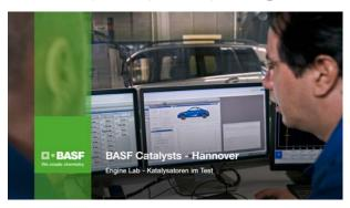
Am Standort Hannover befindet sich die Europazentrale der Abgaskatalysatoren-Sparte mit Forschung, Produktentwicklung, Vertrieb und weiteren strategischen Funktionen. Im Engine Lab werden zukünftige Katalysatortechnologien auf Funktion und Dauerhaltbarkeit unter realen Bedingungen getestet.
