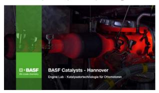
Motorenprüfstand für Ottomotoren: Für den bevorstehenden Test installiert der Techniker einen Pkw-Katalysator im Abgaskatalysatorenprüfstand. Im Engine Lab Hannover werden zukünftige Katalysatortechnologien auf Funktion und Dauerhaltbarkeit unter realen Bedingungen getestet.
